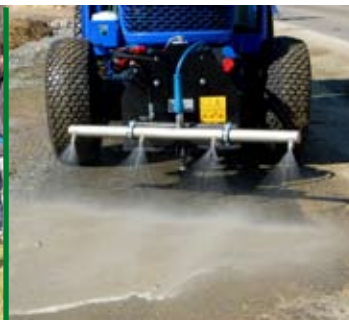
Mehr Wasser, weniger Druck: Der Schwemmbalken entfernt losen Schmutz.
