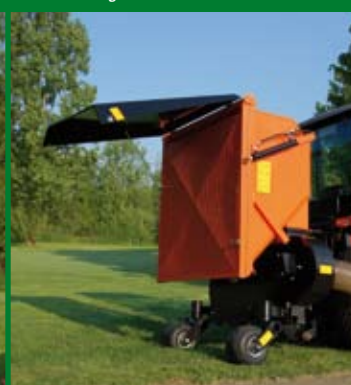
Der Abluftspoiler am Stahlbehälter ist klappbar.
