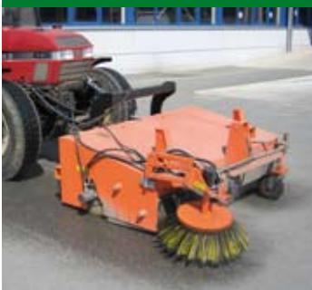
Wasser verhindert die Staubentwicklung bei Kehrarbeiten.
