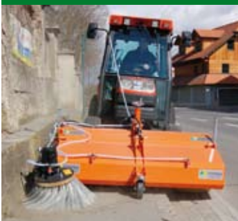
Mit dem dritten Stützrad lassen sich auch schmale Wege reinigen.
