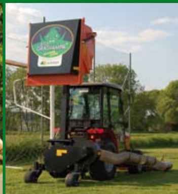
Bestens aufgehoben: Entleerung aus zwei Metern Höhe.
