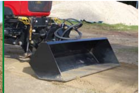
Anpressdruck ermöglicht auch das Planieren von Flächen.
