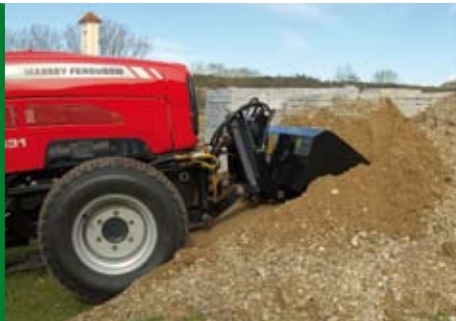
Grabungsarbeiten leicht gemacht: Die Schaufeln fassen je nach Typ bis 210 Liter.
