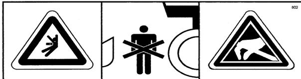
ACHTUNG - QUETSCHGEFAHR, NICHT zwischen Anbaugerät und Trägerfahrzeug treten
