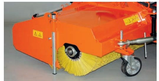
Schmutzsammelbehälter, abgedeckte Hauptbürste, Laufrad
