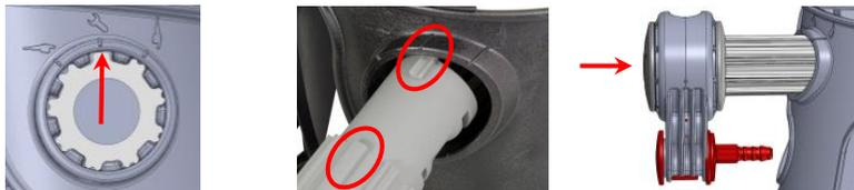
Portare la leva della pompa in posizione di montaggio (angolo di circa 45°), prestare attenzione alla marcatura dell'albero (camma anteriore e nervatura senza scanalatura), inserirla fino all'innesto (prima tacca, posizione di regolazione).
