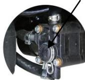
Druck ungenügend: Ansaugschlauch verstopft oder defekt → reinigen oder ersetzen
