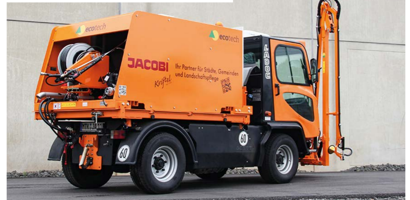
Mit der neuen ecotech Gießanlage, bestehend aus dem Gießarm GA5 und einem passgenauen 2.000 Liter Multiwash-Pritschenaufbau Wassertank, können wieder vor Ort Präsentationen durchgeführt werden. Diesmal mit einem wendigen Ladog T 1700 als Trägerfahrzeug.
