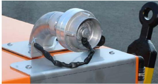
Zur Befüllung: C-Anschluss mit integrierter Abschaltautomatik
