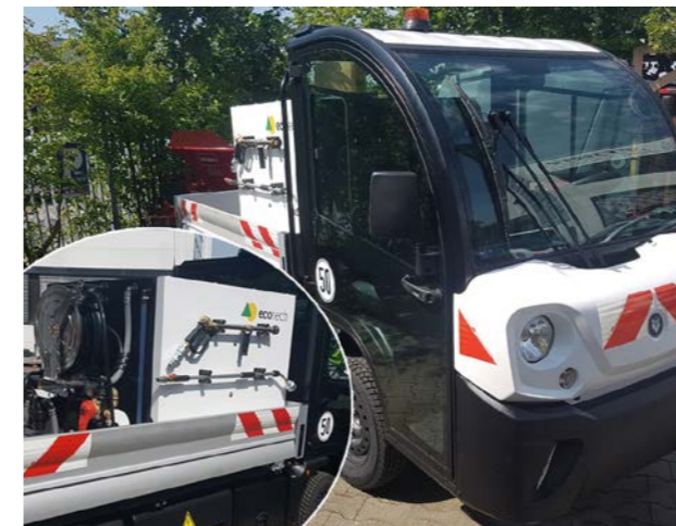
In RAL 9003 – Signalweiß – wurde der elektrisch betriebene ecotech Multiwash-Pritschenaufbau mit 48 V und 600 l Fassungsvermögen lackiert. So ist er farblich auf das Goupil G4 E-Fahrzeug abgestimmt.
