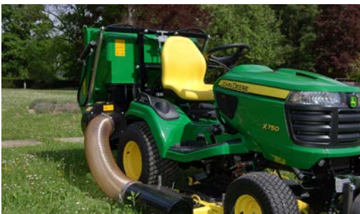
Ansaugstutzen aus Stahl und transparenten Saugschlauch
